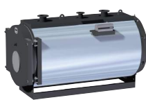
RSW N RSN N 2360 - 6000 kW / 1850 - 3000 kW Caldera para agua caliente con tres pasos de humo, dos de ellos en la cámara de combustión
