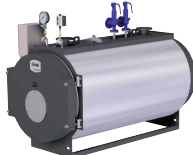
PREX N ASH 160 - 3.500 kW Caldera para agua sobrecalentada hasta 200 °C, con tres pasos de humo, dos de ellos en la cámara de combustión.
