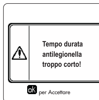
fig. 27 - Messaggio Funzione antilegionella non conclusa
