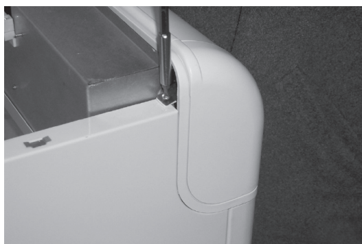
Fig. 8 - Dévisser les deux boulons et les deux plaquettes fixant le panneau de commande.
