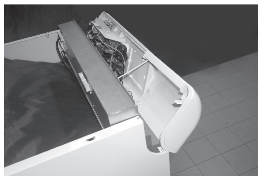
Fig. 9 - Faire tourner vers l'avant le panneau de commande.
