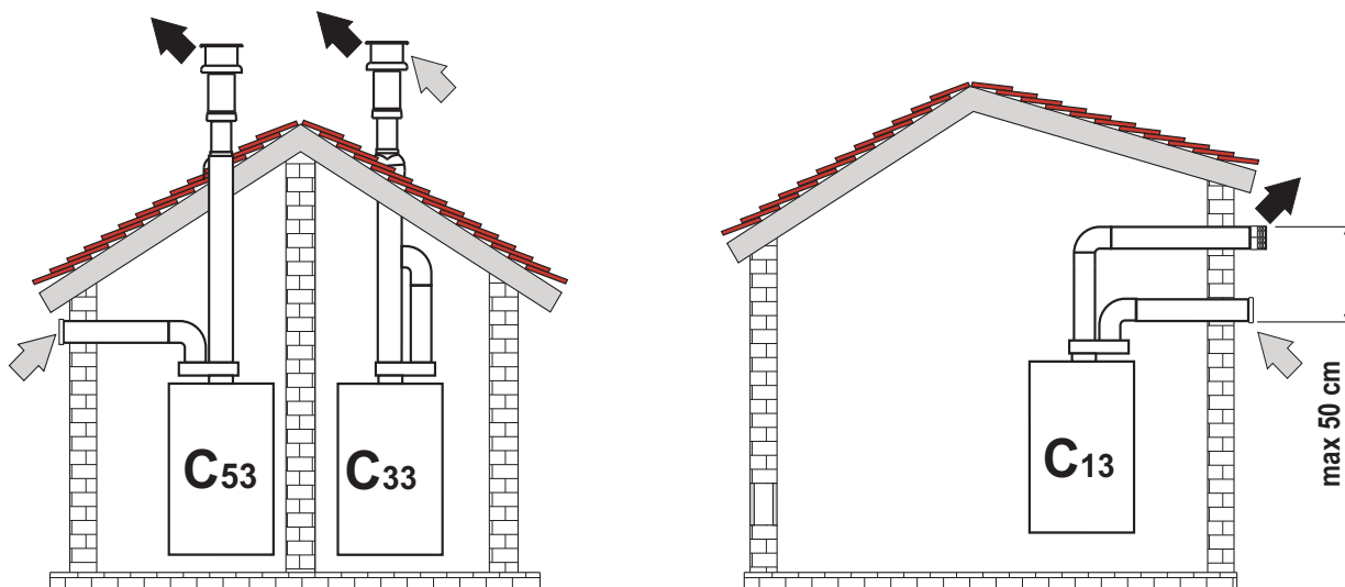
Slika 18- Primeri povezivanja sa odvojenim cevima
