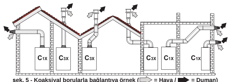
şek. 5 - Koaksiyal borularla bağlantıya örnek (→ = Hava / → = Duman)
