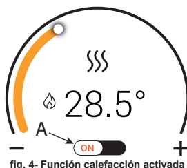
fig. 4- Función calefacción activada
