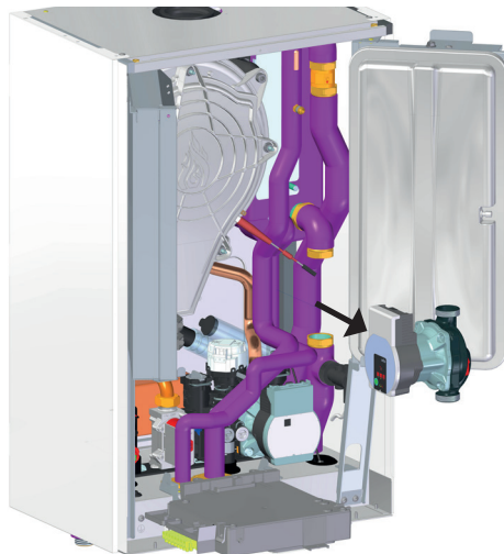
fig. 50 - Vervanging/onderhoud van de circulator van de warmtepomp
