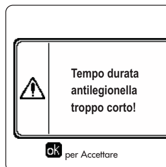
fig. 27 - Messaggio Funzione antilegionella non conclusa
